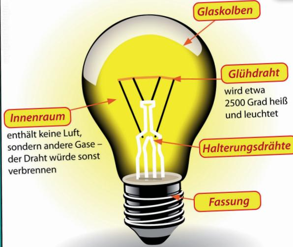
Wenn du das Licht anschaltest, fließt elektrischer Strom durch den extrem dünnen Glühdraht, der dann zu glühen beginnt.
